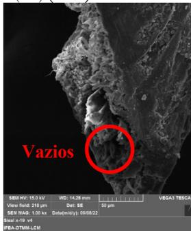
Figura 7d. Fibra com tratamento  $M(T)CKC2020(10)$  (1 kx)
